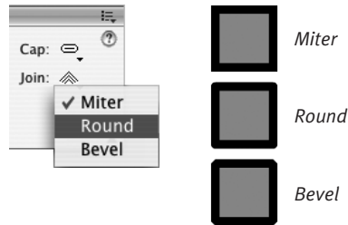
Slika 2.23 Izaberite stil za presecanje linija iz pomoćnog menija Join na kartici Properties panela Property Inspector. Miter daje čist šiljat ugao, Round pravi zaobljeni ugao, a Bevel odseca sa ugla jedan pljosnati deo.
